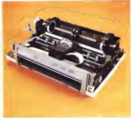
te o meno il movimento a trazione. La testa di stampa è protetta da una calottina di gomma e può essere facilmente sostituita dall'utente semplicemente muovendo due viti che la fissano al carrello che scorre su una cremagliera, la procedura è ampiamente descritta nel manuale in dotazione.
